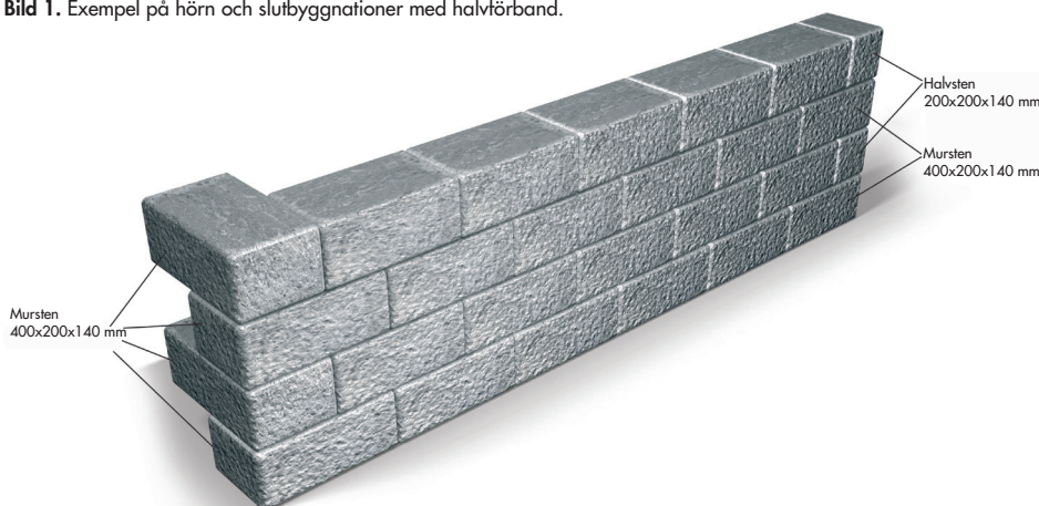
Bild 1. Exempel på hörn och slutbyggnationer med halvförband.
