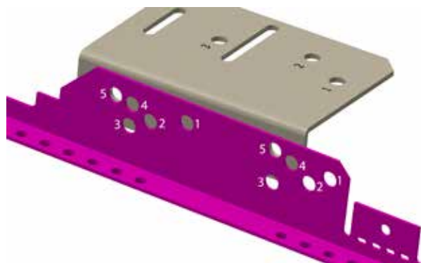
Exempel: Piano hål 5-5 i infästningsenhet mot hål 5-5 i konsolfäste.
