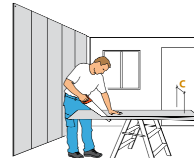
7- Klyv skivan enligt breddmålet. Lämnar 2-3mm luftspalt mot anslutande väggar.
