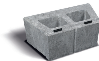
Bild 8. Distans till Megasmart, se placering på murblocket. Antal distanser vid lutande mur är 32 st/m 2
