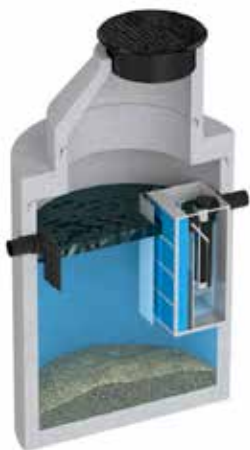
Koalescensoljeavskiljare och Lamelloljeavskiljare, båda med integrerat slamsfång och automatisk avstängningsanordning.
