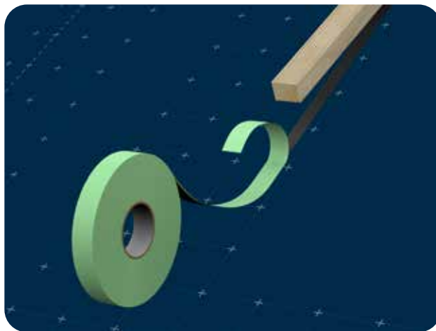
Tätning med butylband mellan underlagsduk och ströläkt.
