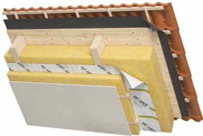
Isover Vario® Xtra monteras i snedtak, därefter monteras korsreglar för installationsskikt.
