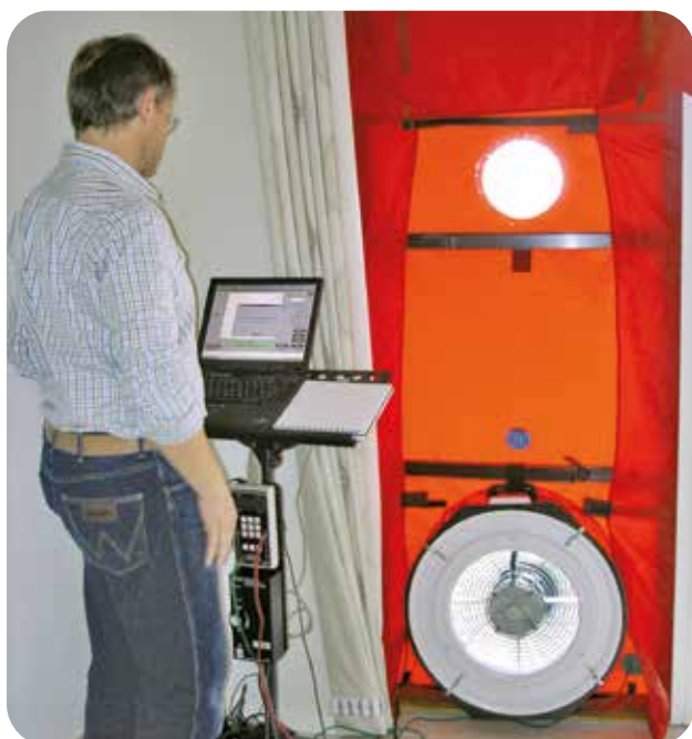
Tryckprovning enligt Blower door-metoden.
